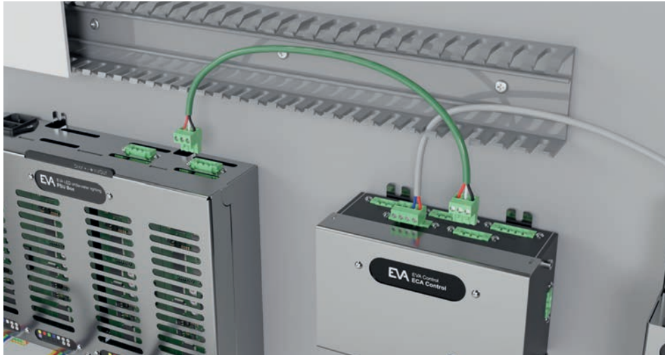
Collegare il cavo DMX incluso dal controllo EVA alla scatola dell'alimentatore
