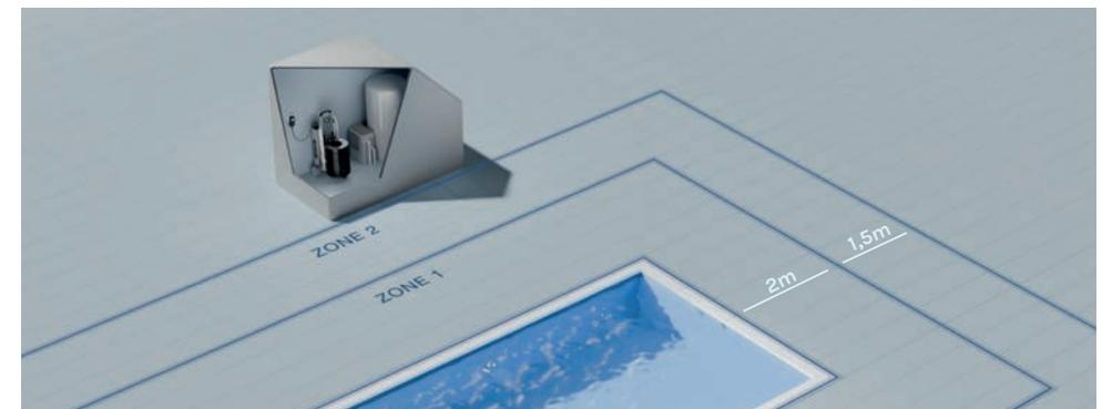
Aunque está estrictamente prohibido cargar la EVAstream Move mientras se encuentra dentro o cerca del agua (la unidad debe situarse a una distancia mínima de 3,5 m, fuera de la zona 2 de la piscina), el interruptor PRCD es una medida de seguridad adicional dirigida a minimizar el riesgo de descarga eléctrica resultante del contacto (involuntario) con el agua.
